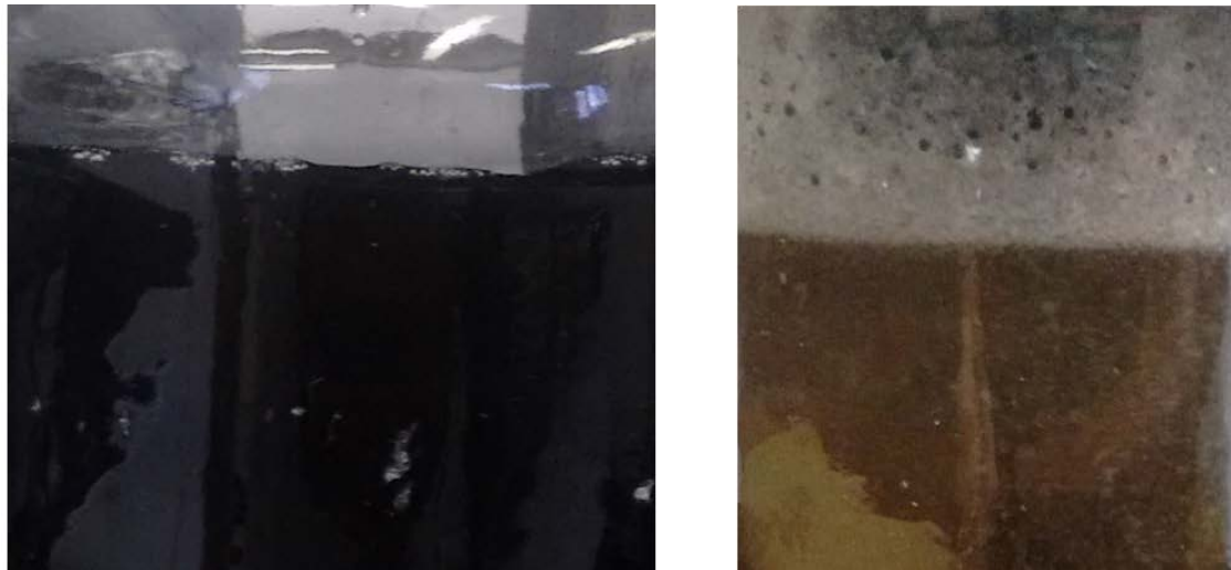
Figura 2: Lixiviado antes do início da eletrocoagulação e após 10 minutos de tratamento, apresentando a separação de fases.
